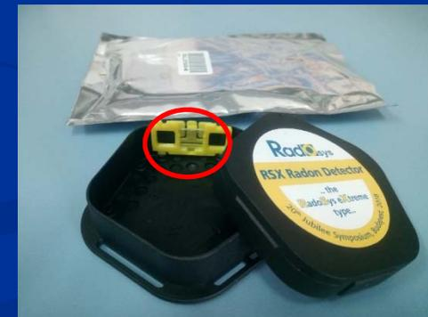
Insensibles a la humedad, temperatura, radiaciones beta y gamma de fondo
