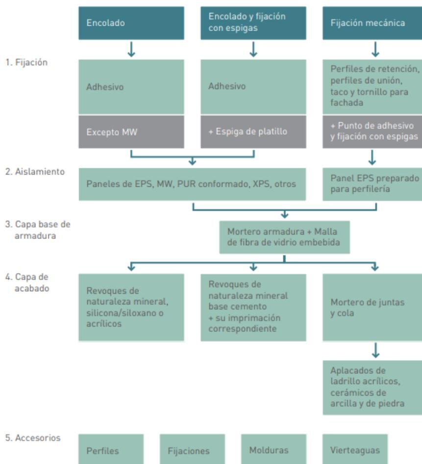
Figura 2. Componentes de un sistema SATE
