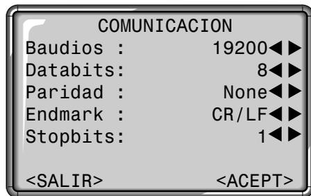
Para transmitir datos entre el PC y el instrumento hay que establecer previamente los parámetros de comunicación de la interfaz serie RS232.
