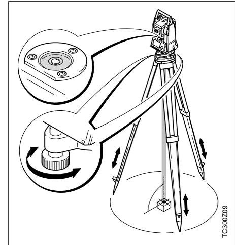
7. Calar el nivel esférico modificando la altura de las patas del trípode. El instrumento está ahora aproximadamente nivelado.
