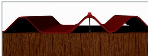
Con tejas curvas, para pendientes inferiores al 60% se necesitan 3 fijaciones por m<sup>2</sup>. Para pendientes superiores 3,5 por m<sup>2</sup>.
