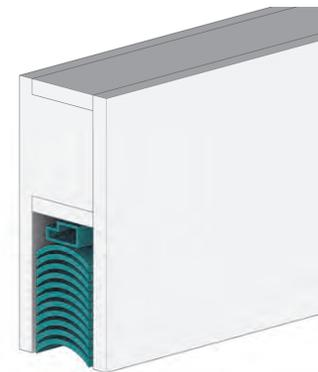
*Ilustración 61: Cajas de persiana para SATE con puente térmico mitigado. Fuente: Fuente: M. Epelde, A. Intxausti.*
