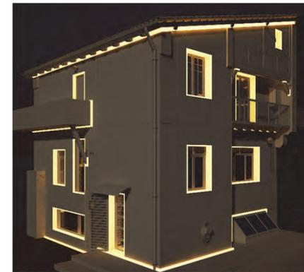
Ilustración 25: Puentes térmicos analizados en el edificio modelo.
