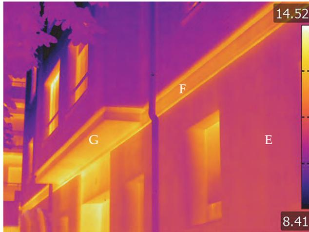
*Imagen 2: Detalle de ausencia de continuidad de envolvente térmica provocando discontinuidad en la envolvente en el suelo del mirador, canto forjado y planta baja. Fuente: Marta Epelde.*
