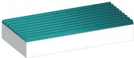
Ilustración 33: Adhesivo en superficie
