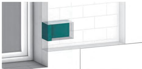
*Ilustración 59: Accesorio para elementos críticos como barandillas, protecciones anticaídas, guías de persianas de panel deslizante o contraventanas. Fuente: Fuente: M. Epelde, A. Intxausti.*
