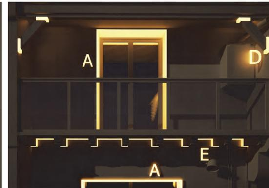
Ilustración 11: Encuentros que impiden la continuidad del aislamiento: fachada con forjado de balcón y solivos (letra E) y huecos (letra A). Fuente: M. Epelde, A. Intxausti.
