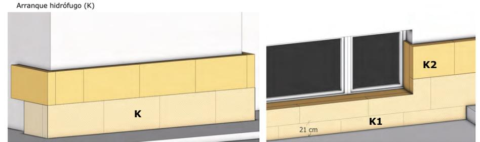
Ilustración 64: Arranque con hilada de aislamiento hidrófugo en fachada principal. Fuente: M. Epelde, A. Intxausti.
