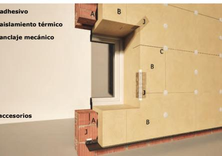
Ilustración 29: Instalación de perfileras tras la ejecución del aislamiento y anclajes. Fuente: M. Epelde, A. Intxausti.
