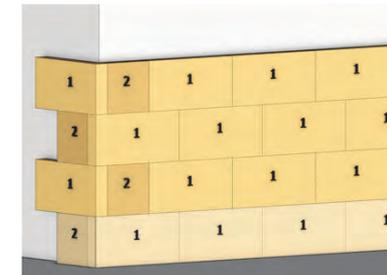
Ilustración 48: Tercera y cuarta hilada de colocación del SATE en el caso de instalación del SATE por fachadas. Fuente: M. Epelde, A. Intxausti.
