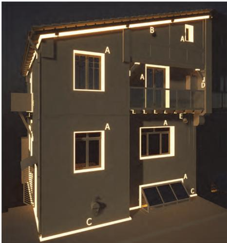
Ilustración 8: Encuentros que impiden la continuidad de la envolvente (fachada principal). Fuente: M. Epelde, A. Intxausti.
