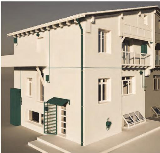
Ilustración 26: Instalaciones a reponer que requieren elementos especiales para pesos en la fase de instalación de aislamiento.
