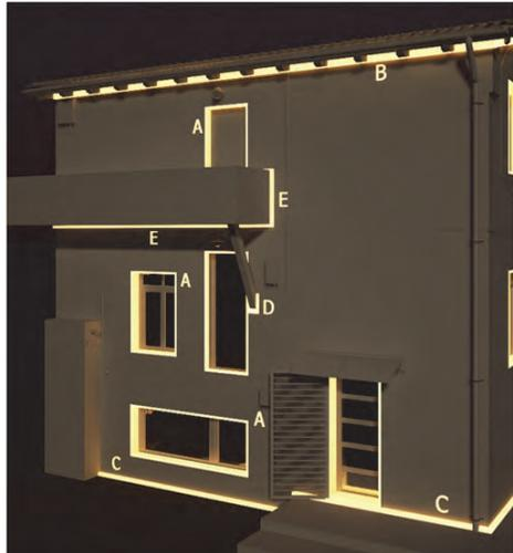
Ilustración 9: Encuentros que impiden la continuidad de la envolvente (fachada lateral). Fuente: M. Epelde, A. Intxausti.
