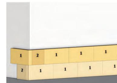
Ilustración 46: Segunda hilada del SATE en el caso de instalación del SATE por fachadas. Fuente: M. Epelde, A. Intxausti.
