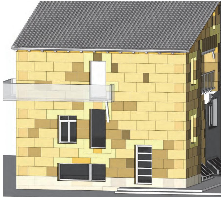
Ilustración 75: Resultado final del planteamiento de placas de aislamiento en la fachada lateral. Fuente: M. Epelde, A. Intxausti.
